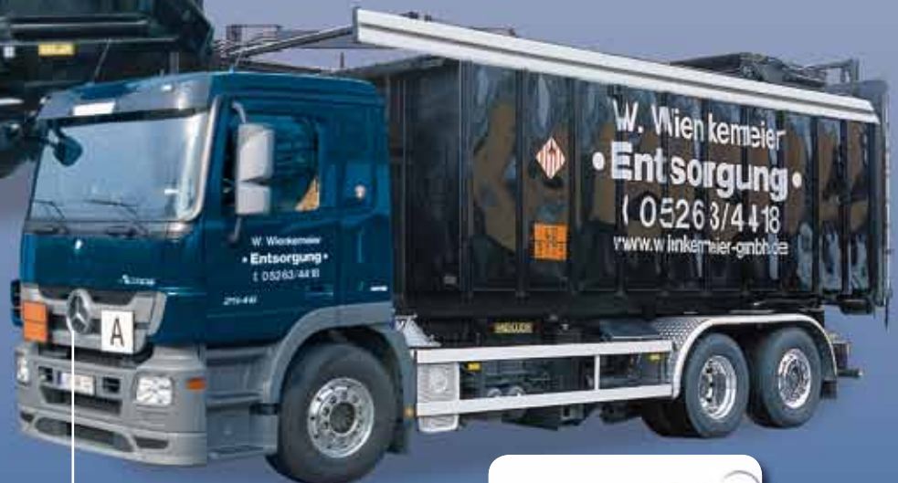
30-m 3 -Spezialaufbau GGVE zum Einsammeln und Befördern von överunreinigten Betriebsmitteln
