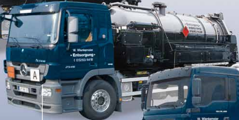
12-m 3 -GGVSE-Saugwagen mit Hochdruckspül-Einrichtung Aufbauten wechselbar
