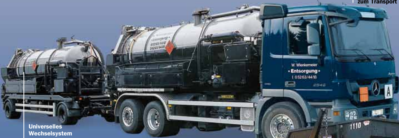
8- bis 12-m 3 -GGVSE-Saugwagen zum Transport von Ölen
