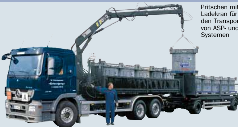
Wechselaufbauten für Großcontainer 2 x 30 m 3 mit Anhänger nach GGVS
