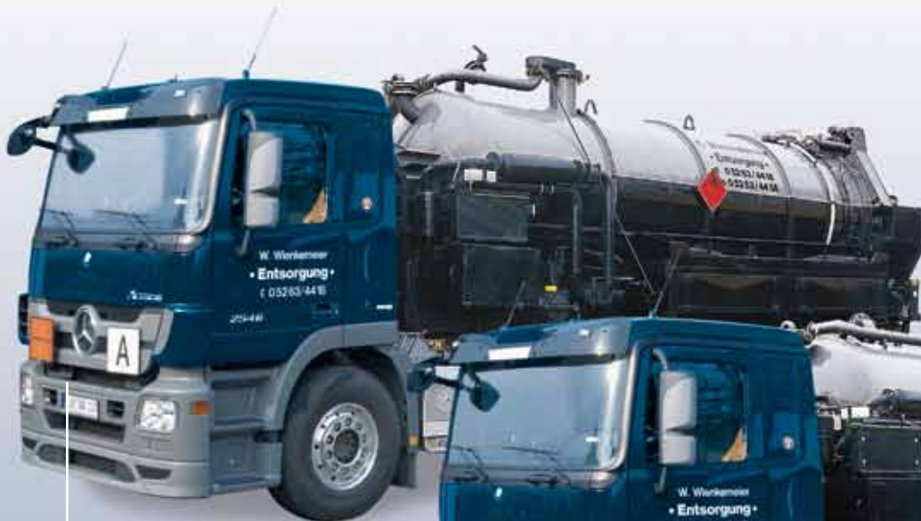
12-m 3 -GGVSE-Saugwagen mit Hochdruckspül-Einrichtung Aufbauten wechselbar
