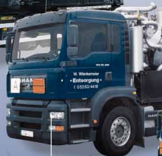
8- bis 12-m 3 -GGVSE-Saugwagen zum Transport von Ölen
